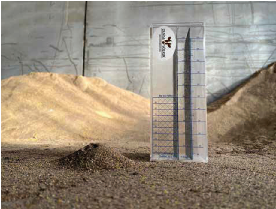
Der Vermahlungsgrad des Kraftfutters sollte bei jeder Lieferung, am besten mithilfe eines Siebkastens, überprüft werden (hier: Siebkasten mit drei Fraktionen: < 1 mm, 1–2 mm und > 2 mm).
